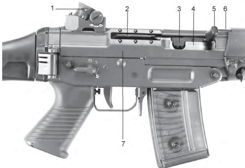
Abbildung 3: Verschlussgehäuse
